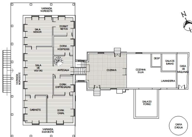
Figura 20 – Planta baixa esquemática do pavimento principal, com o setor de serviços á um nível mais baixo.
